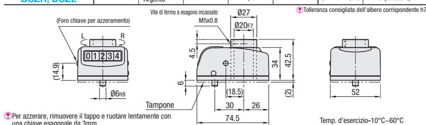
Per azzerare, rimuovere il tappo e ruotare lentamente con una chiave esagonale da 3mm
