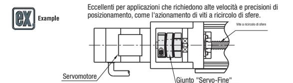
Eccellenti per applicazioni che richiedono alte velocità e precisioni di posizionamento, come l'azionamento di viti a ricircolo di sfere.
