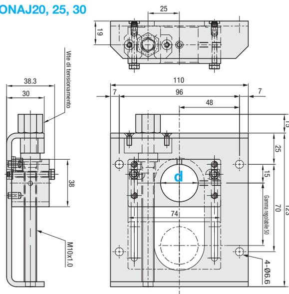
Schema dello stato di montaggio del rullo Ø80
