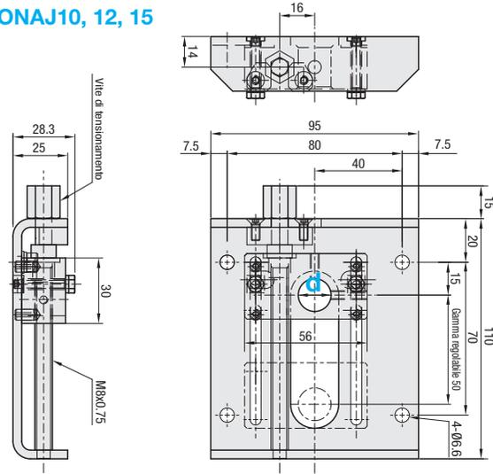
Schema dello stato di montaggio del rullo Ø60
