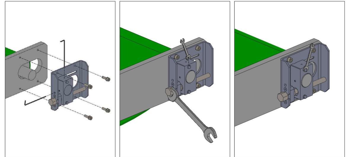
1. Montare il corpo principale sul telaio. Montare il rullo (pignone folle).
