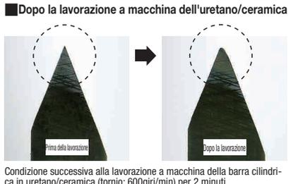
Risultati della prova di abrasione Taber
