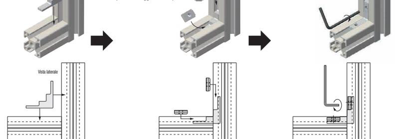
**Caratteristiche:** staffe a scomparsa per il collegamento di profilati da 40, 30mm.
