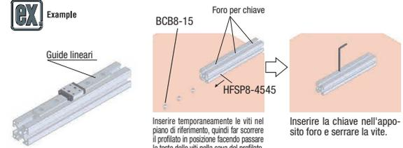
Poiché le sezioni sono estruse, il prodotto potrebbe torcersi. Si consiglia di sostenere l'intera lunghezza del profilato durante l'uso. Vedere Dati tolleranze profilati in alluminio a P.514.
