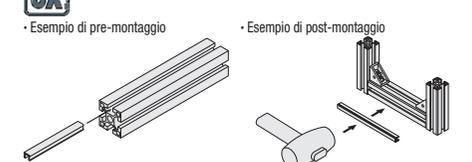
Installabile su profilati assemblati. A tal fine, utilizzare un mazzuolo in legno o in resina.
