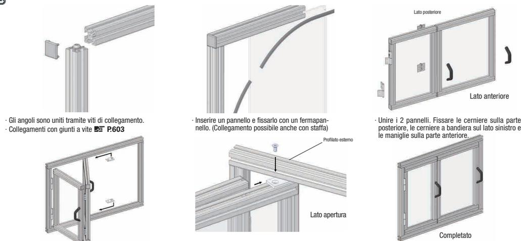
La fluidità di scorrimento della porta dipende dalla tolleranza del profilato in alluminio e dalla precisione del montaggio. Accertarsi di regolare con precisione la posizione dei cursori.
