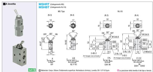
©Il corpo del tipo a levetta ha lo stesso profilo/dimensione del tipo a pulsante. Per le dimensioni corpo dettagliate, vedere i disegni del tipo a pulsante (MSHRP, MSHBP) sopra.
